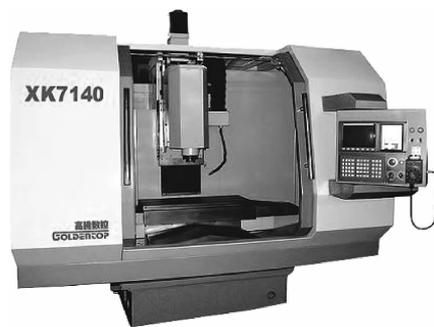
图 2-1-2 全封闭式数控铣床
