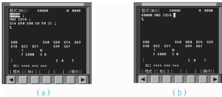
图 2-1-12 FANUC 0i MC 数控系统 MDI 操作
