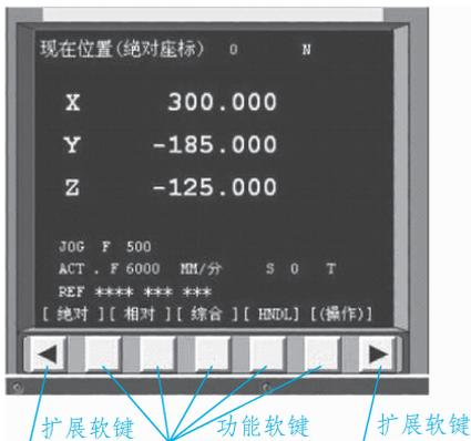
图 2-1-4 FANUC 0i MC 数控系统 LED 显示区
