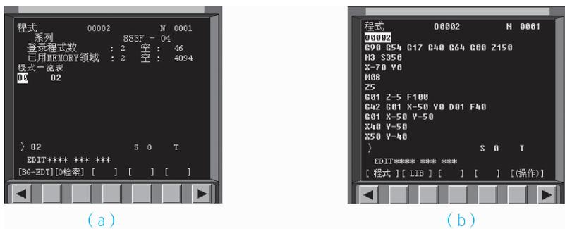
图 2-1-14 FANUC 0i MC 数控系统打开程序操作
