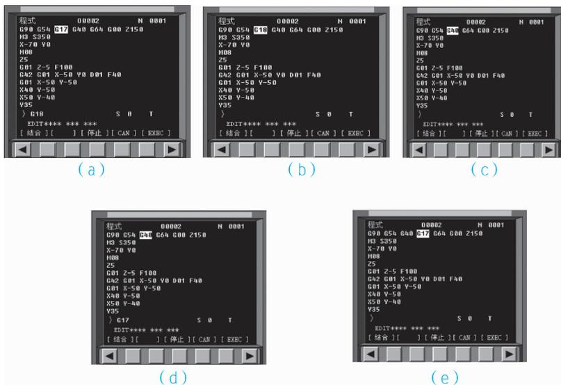
图 2-1-15 FANUC Oi MC 数控系统程序的编辑操作
