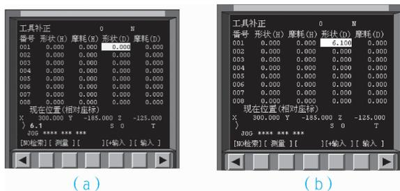
图 2-1-17 FANUC 0i Mate—MC 数控系统刀补设定操作
