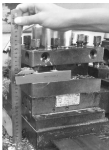
图 1-1-14 用钢直尺测量对中心
